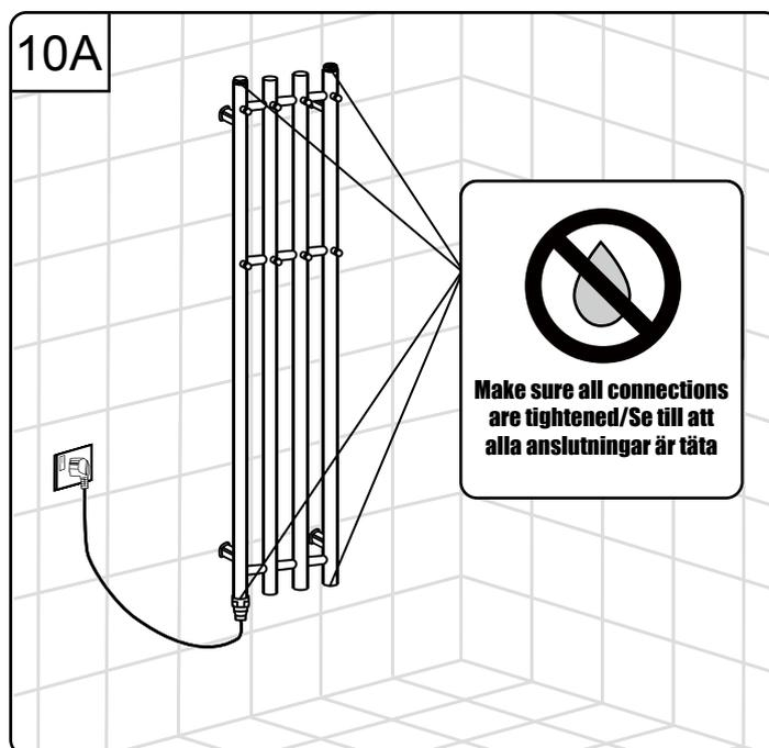
**For The Central Water Heating System/Anslutning till slutet värmesystem/
