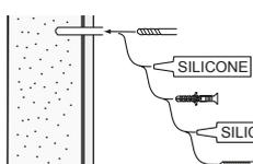
Skruvinfästningar i våtzon 1 ska göras i betong eller annan massiv konstruktion, träreglar, träkortlingar eller i konstruktion som är provad och godkänd för infästning, till exempel skivkonstruktion. Se exempel på godkända konstruktioner på säkervatten.se.
