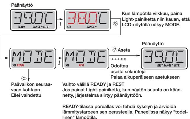
REST-tilassa lämpötilaa ei kysytä, ja lämmitys tapahtuu ainoastaan suodatusjaksojen aikana. Todellinen lämpötila ei näy paneelissa koko aikaa.
