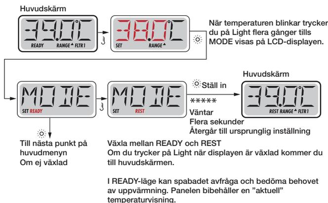
REST-läge avfrågar inte och uppvärmning körs endast under filtercykler. Panelen visar inte alltid aktuell temperatur.
