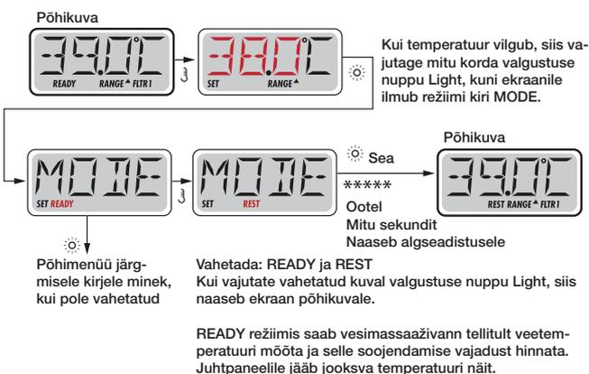
Ooterežiimis REST ei toimu tellitud mõõtmist ja soojendamine toimub ainult filtritsüklite ajal. Juhtpaneel ei näita alati jooksvat temperatuuri.
