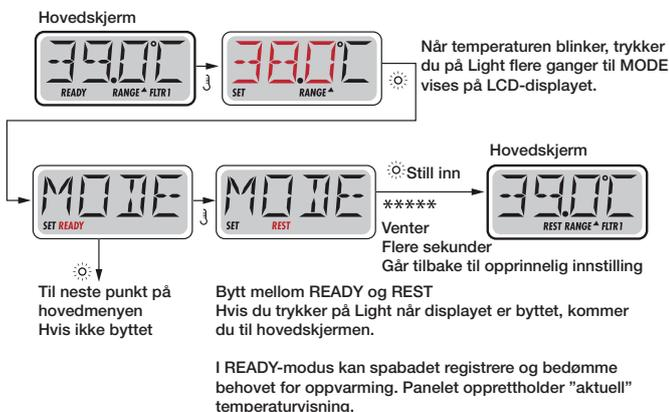
REST-modus registrerer ikke, og oppvarming kjøres kun under filtersykluser. Panelet viser ikke alltid aktuell temperatur.
