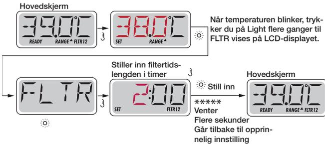
Hvis Filtersyklus 2 er deaktivert, vises Filter 12 på LCD-displayet. Hvis filteret er deaktivert, vises Filter 1.
